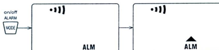
Halten Sie die MODE – Taste für ca. 2 Sekunden gedrückt. Erscheint im Display die Anzeige „ALM“ und **•)))**, ist die Alarmfunktion eingeschaltet. Wird der Alarmgrenzwert überschritten erscheint in der Anzeige das Symbol ▲.
