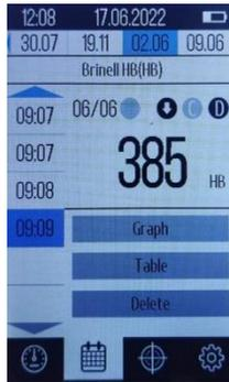
Abbildung 2.11 - Registerkarte mit den gespeicherten Messwerten
