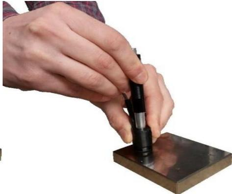
Abbildung 1.4 - Aufladen der Feder der Sonde
