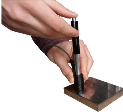
Abbildung 1.5 - Drücken der Auslösetaste der Sonde
