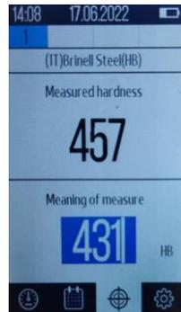
Abbildung 2.50 - Eingabe des spezifischen Wertes der Kalibriermessung
