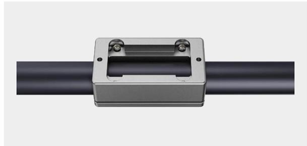
Richten Sie den Durchflussmesser an der Rohrposition aus, bringen Sie die Schraube am oberen Teil der Halterung an. Dann wird der untere Teil der Halterung automatisch mit dem oberen Teil verbunden. Befestigen Sie die vier M4-Schrauben.
