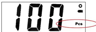
3. Mit der „PRINT / UNIT“ Taste können Sie zwischen den Zahlen 5 / 10 / 20 / 25 / 50 / 75 oder 100 wechseln. Wählen Sie die Zahl aus, die mit der von Ihnen benutzten Referenzanzahl übereinstimmt und bestätigen diese mit der „STÜCKZÄHLUNG / ENTER“ Taste. Die Zahl blinkt nicht mehr und die Waage ist nun im Zählmodus. (siehe Bild)
