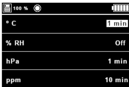
Abb. 10 Sensorauswahlmenü - Abtastzeit für Temperatur ändern
