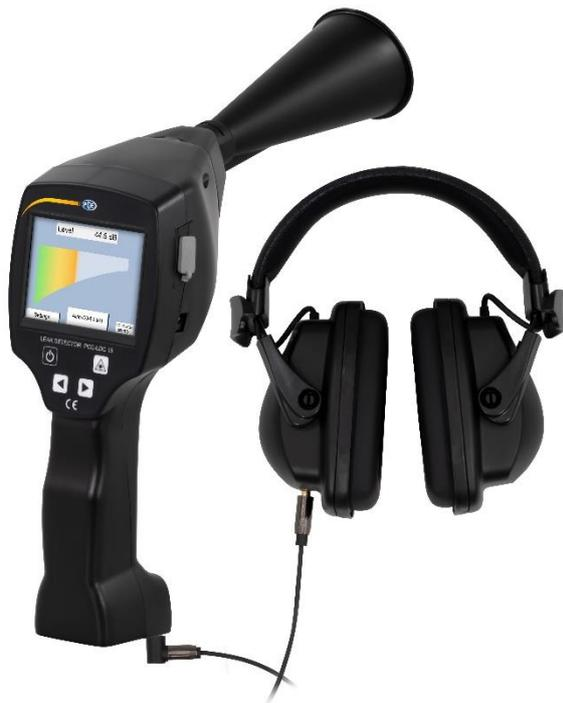
Das neue Leckageprüfgerät PCE-LDC 15 wird überall dort eingesetzt, wo es zu Ausströmung von Gasen aus Leckagen in Rohrleitungssystemen kommen kann. Zum Beispiel an Druckluft-, Gas-, und Vakuumanlagen in der Industrie sowie an Türdichtungen. Die Arbeitsfrequenz von dem Leckageprüfgerät liegt bei 40 kHz ( $\pm 2$  kHz).
