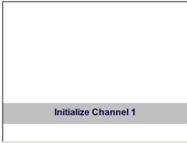
Nach dem Einschalten des PCE-LDC 15 erfolgt die Initialisierung und wechselt danach in Leckage Anzeige
