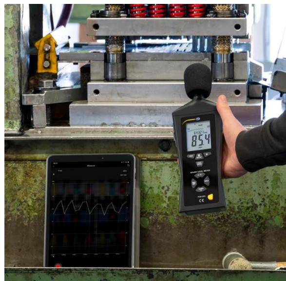
Egal ob für Lärmmessungen in Betrieben, im Wohnumfeld oder im Freizeitbereich, das PCE-323 überzeugt durch Funktionalität und einfache Handhabung. Um das Gerät bei Dauermessungen in der richtigen Höhe sicher positionieren zu können, gehört beispielsweise ein Ministativ zum Lieferumfang. Zur Befestigung darauf genügt der passende Gewindeanschluss auf der Rückseite.
