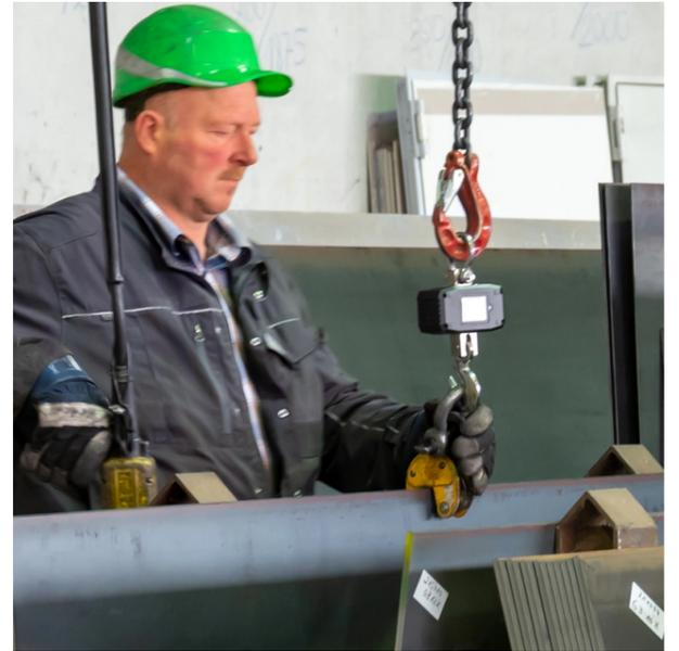
Kranwaage mit einem Messbereich von 0 ... 1000 kg / hintergrundbeleuchtetes LC-Display / Batteriebetrieb / robustes Metallgehäuse / "Hold", "Tara" und "MAX" Funktion / verschiedene Masseinheiten / optional mit ISO Kalibrierzertifikat
