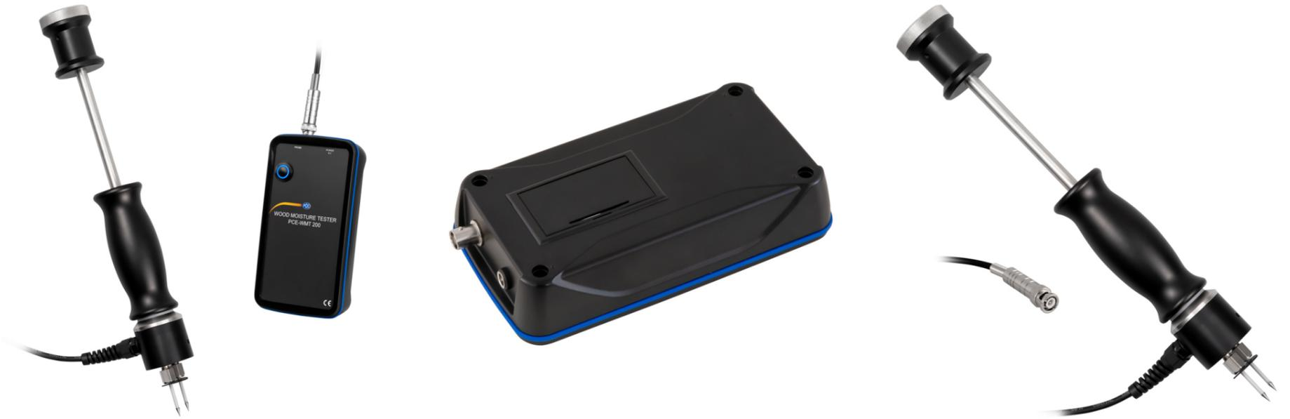
**Bluetooth Baufeuchtemessgerät mit Rammelektrode / für 44 verschiedene Holzarten / Batterie- als auch Netzbetrieb / zwei verschiedene Nadelpaare / Temperaturkompensation / geeignet zur Überprüfung der Einhaltung der "1. Bundes-Immissionsschutzverordnung"**
