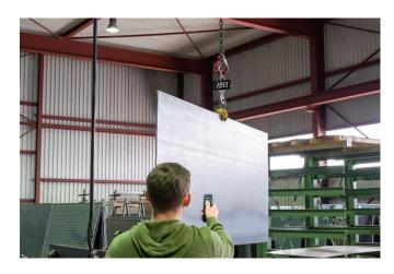
Die kompakten Hängewaagen lassen sich gut in Bereichen einsetzen, in denen große und sperrige Teile gewogen werden müssen. Sie sind leicht und kompakt, so dass sie schnell und problemlos zu einem anderen Anschlagpunkt getragen werden können. Trotzdem ist das aus Metall gefertigte Gehäuse sehr robust und widerstandsfähig. Die energiesparende Technik ermöglicht eine Betriebszeit von ca. 45 Stunden mit einem Batteriesatz.
