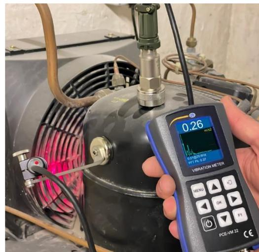
Mit dem neuen Vibrationsmessgerät der PCE Deutschland GmbH können nicht nur Schwingungswerte, sondern auch Drehzahlen und Oberflächentemperaturen von Bauteilen sofort im selben Gerät erfasst und damit besonders einfach der Messstelle und dem Messzeitpunkt zugeordnet werden. Dies erleichtert sowohl den Ablauf von Routinekontrollen zur vorbeugenden Instandhaltung, als auch die Suche nach den Ursachen bei Unregelmäßigkeiten und Abweichungen.
