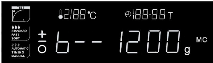
Mit den Pfeiltasten können Sie diese nun ändern. Zur Auswahl stehen 1200 / 2400 / 4800 / 9600. Um die gewünschte Auswahl zu übernehmen, drücken Sie die RESET-Taste und das Gerät wechselt in den Messmodus.
