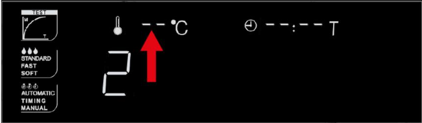
Als Erstes blinkt der Platzhalter für den Zehnerschritt. Diese lässt sich von 0 bis 19 einstellen, womit auch die Hunderterziffer abgedeckt wird. Mit der Enter-Taste bestätigen Sie die Eingabe und das Gerät wechselt zur Einerziffer. Diese kann von 0 bis 9 eingestellt werden und wird wieder durch die Enter-Taste bestätigt.
