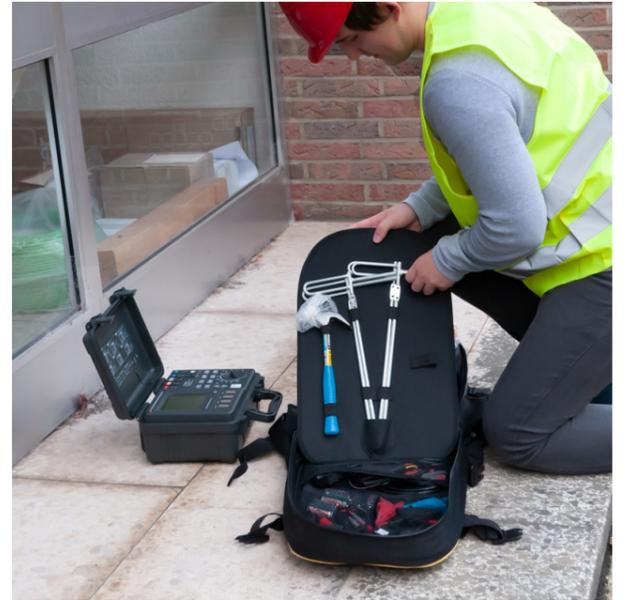
**Erdungsmesser mit Speicher / mobiler Einsatz dank Akku möglich / Widerstandsmessung / Schutzleiterprüfung / visuelle Anschlusshilfe / Blitzableiterprüfung / Hintergrundbeleuchtung
