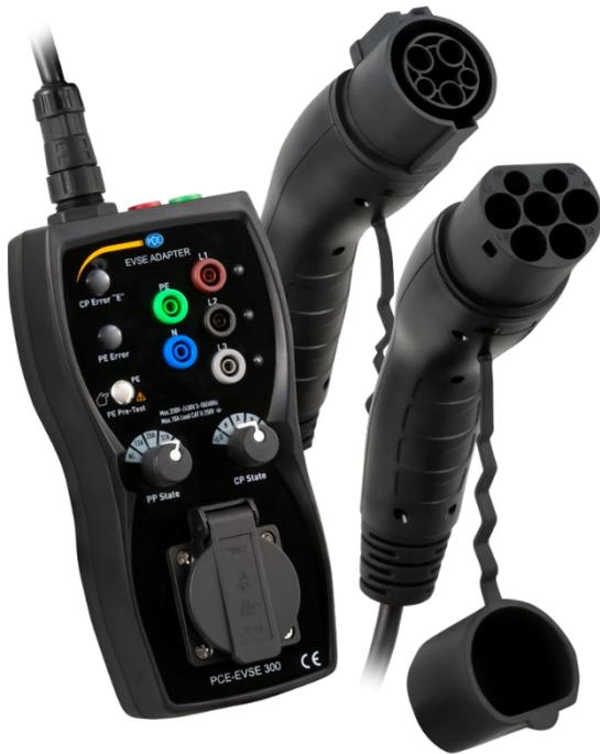
Der neue EVSE Adapter PCE-EVSE 300 der PCE Deutschland GmbH ermöglicht zusammen mit einem geeigneten Installationstester die Kontrolle der elektrischen Sicherheit und der korrekten Funktion von Ladestationen der Ladebetriebsart 3. Dabei spielt es keine Rolle, ob die Ladestation mit einem Steckeranschluss oder einem fest installierten Ladekabel ausgestattet ist. Über die beiden zum Lieferumfang gehörenden Adapterkabel für Typ 1 und Typ 2
