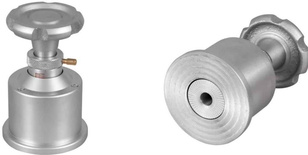
**Rund - Probenschneider für 10 cm<sup>2</sup> Proben, robust und kompakt, vier Klingen, 0-5 mm**
