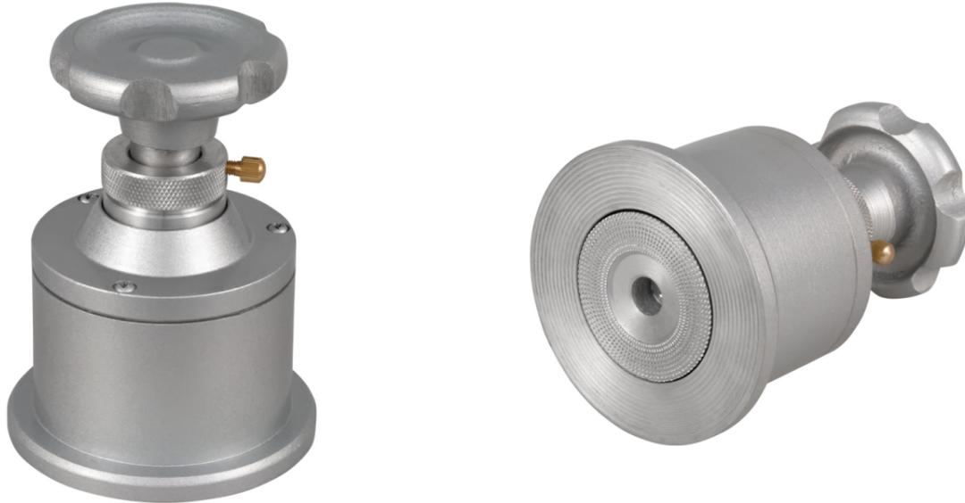
**Rund - Probenschneider für 25 cm<sup>2</sup> Proben, robust und kompakt, vier Klingen, bis 0-5 mm**
