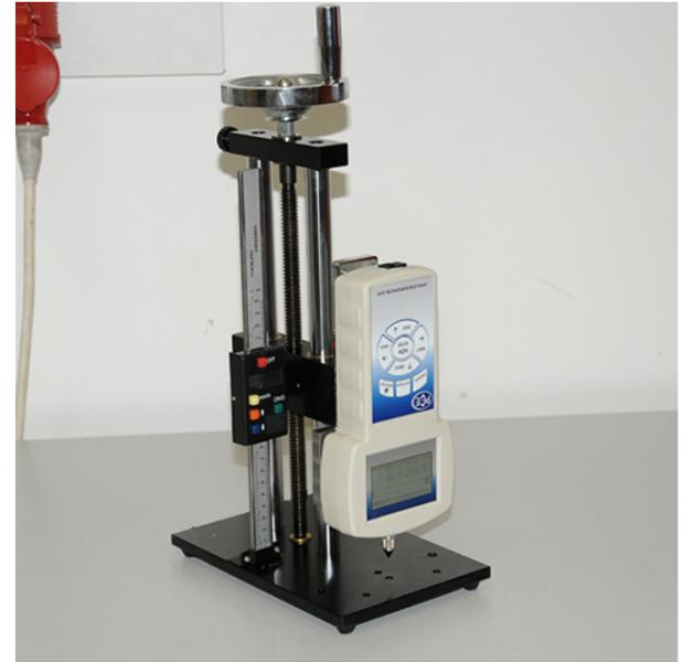
manueller Kraft-Weg-Messstand bis 500 N, verschiedene Kraftmesser mit interner Kraftmesszelle anschließbar, über 300 mm Hub, integrierter Hubmesser
