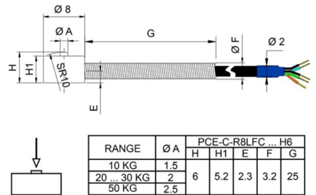
Der Miniatur – Kraftsensor ist besonders aufgrund seiner kompakten Abmessungen in vielen Einsatzbereichen zu finden. Mit einer geringen Kräfteinleitungsfläche ermöglicht der Miniatur – Kraftsensor die Kraftmessung an kleinen Kontaktflächen.
