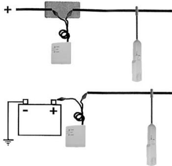
Halten Sie die Taste „TEST“ am Empfänger gedrückt und folgen Sie mit dem Sensor dem Signal und damit der Leitung.
