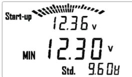
Die niedrigste Spannung während des Startvorgangs sollte 9,6 V bei einer Batterie (12 V) und 16 V bei zwei Batterien (24 V) nicht unterschreiten.
