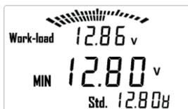
Die minimale Ladespannung unter maximaler Belastung sollte bei einer Batterie (12 V System) 12,80 V und bei Zwei Batterien (24 V System) 25,60 V nicht unterschreiten. Bei einer Unterschreitung kontrollieren Sie den Keil- / Zahnriemen und die Lichtmaschine auf Beschädigungen und Funktion.
