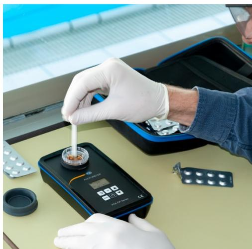
Die Photometer der PCE-CP Serie speichern automatisch bis zu 255 Messwerte und können über eine Bluetooth-Schnittstelle per Android App ausgelesen und über einen Cloud-Service von mehreren Geräten aus eingesehen werden. Die App erlaubt die Verwaltung unterschiedlicher Messorte und ist wie der Cloudservice kostenfrei nutzbar. In Kürze wird auch eine iOS App und Software für Windows und MacOS für die Photometer der PCE-CP Serie kostenlos zur Verfügung stehen.
