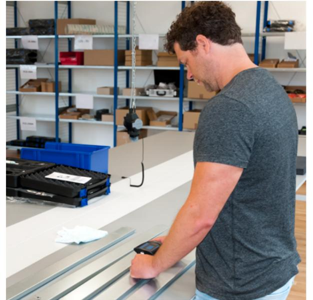
**Glanzmessgerät PCE-GM 60Plus für den nicht-stationären Einsatz / Messung bis 200 Glanzpunkte /
