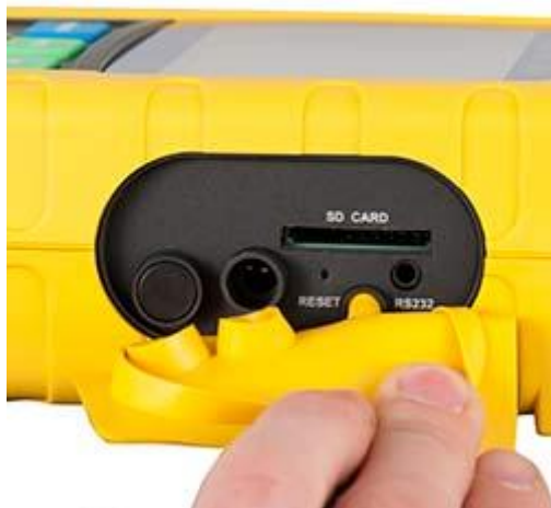
Die Anschlüsse vom 4-Kanal-Vibrationsdatenlogger PCE-VM 5000.
