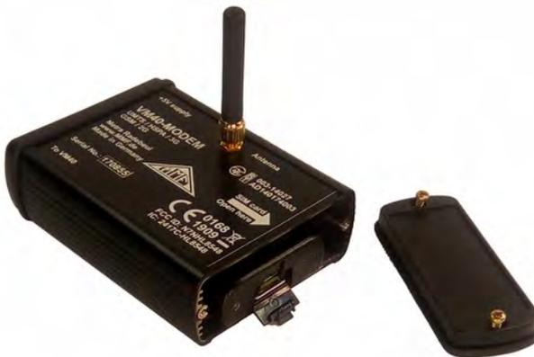
Bild 41: Wechseln der SIM-Karte
