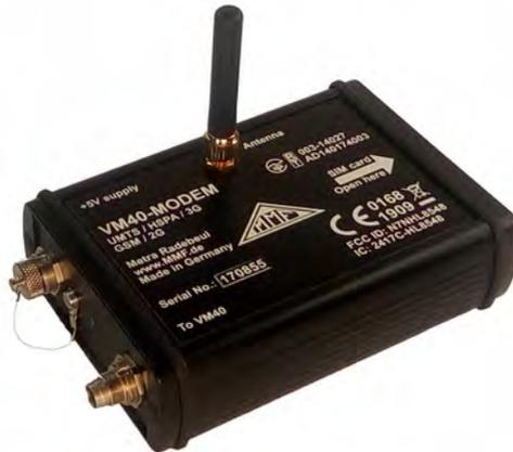
Bild 40: Mobilfunkmodem PCE-VM40-MODEM
