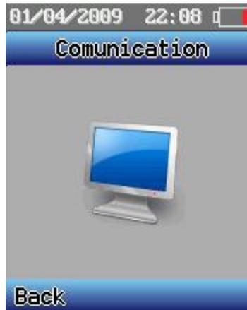
Das Gerät wird mit dieser Funktion wie in USB-Stick angezeigt. Der Computer kann Messdaten und Messkurvendaten vom Gerät herunterladen bzw. hochladen.
