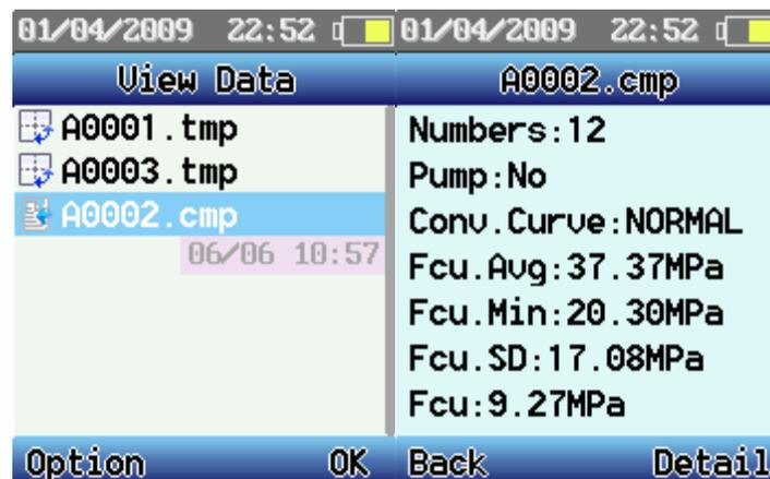
Wählen Sie eine Komponente mit der OK-Taste und drücken Sie für Details auf „Detail“.
