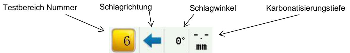
Gehen Sie in die [Sampling] Auswahl um mit der Messung zu beginnen. Wenn Sie die Schlagrichtung, Schlagwinkel und Karbonatisierungstiefe messen, drücken Sie auf die „Set“ -Taste Sie können nun die Parameter einstellen, ändern oder den zuletzt aufgenommenen Wert löschen.
