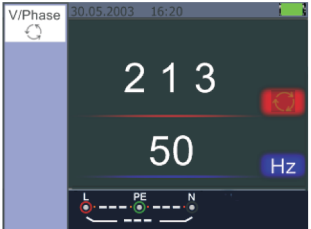
Abb. 5.2.8.4 Phasensequenz wenn gegen den Uhrzeigersinn verbunden.
