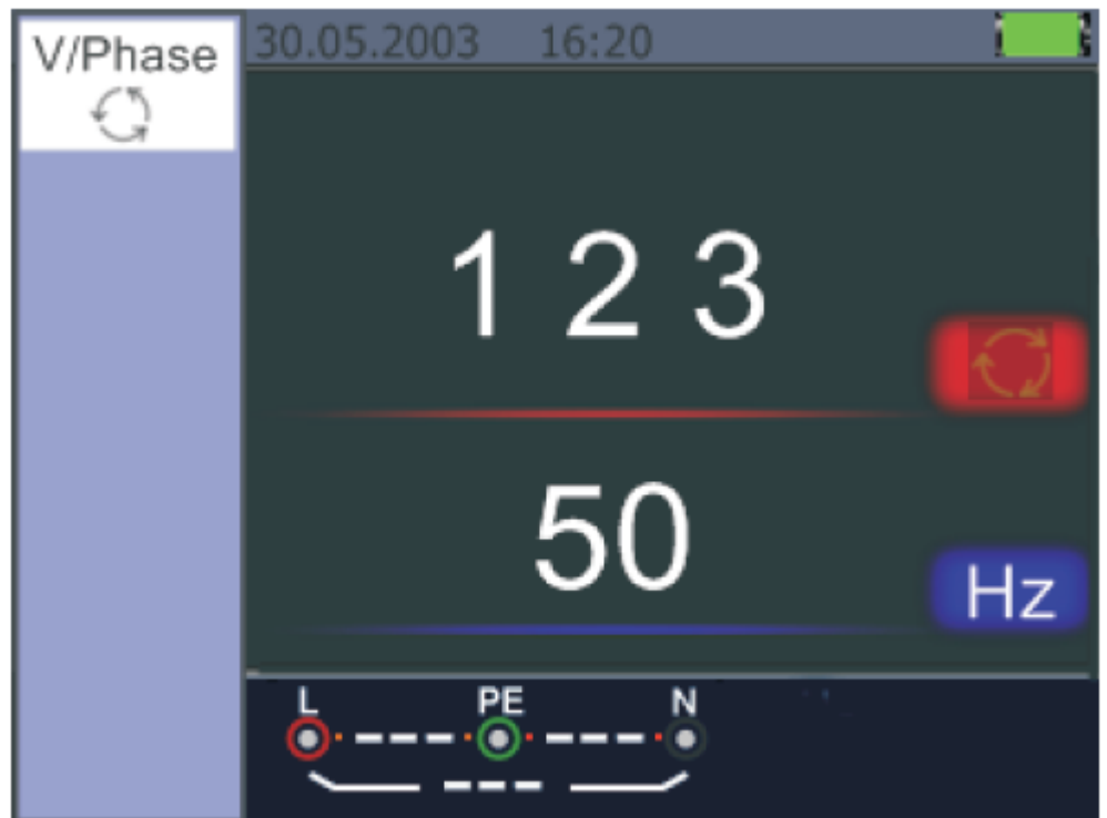
Abb. 5.2.8.3 Phasensequenzbildschirm wenn im Uhrzeigersinn verbunden.
