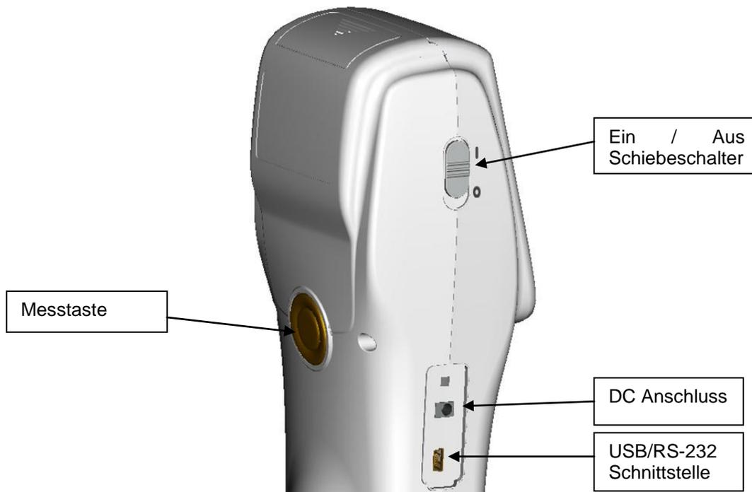
Abbildung 1: Schnittstellen / Anschlüsse
