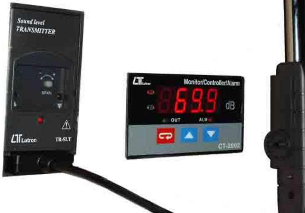
Hier sehen Sie die Schallwarnanlage - SLT in Betrieb. Die Schallwarnanlage ist für die Dauermessung vorgesehen und wird einsatzfähig geliefert. Die Verkabelung ist das Einzige, welches der Kunde selbst vornehmen muss. Somit ist das Schallüberwachungsgerät schnell zur Messung einsatzfähig.
