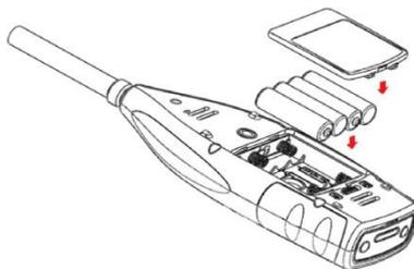
Wechseln Sie die Batterien und verschließen verriegeln Sie die Batteriefachabdeckung wieder.
