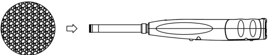
Drücken Sie den Windschutz entsprechend der oberen Abbildung fest bis zum Anschlag auf das Mikrophon. Weitere Details für Korrekturen des Windschutzes im Freien finden Sie unter 12.2 Korrekturen des Windschutzes im Freien.
