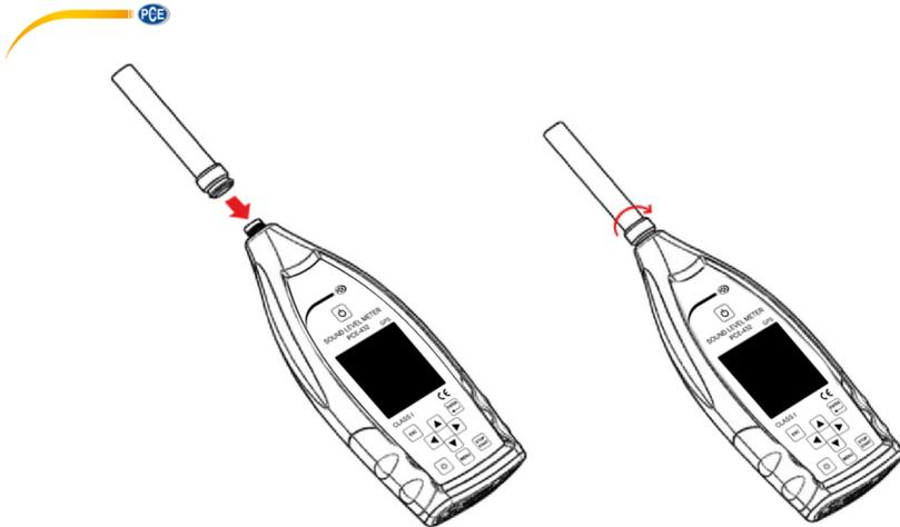
Schließen Sie das Mikrophon an den TNC-Verbinder an. Drehen Sie anschließend das Gewinde, bis die Teile fest verbunden sind.
