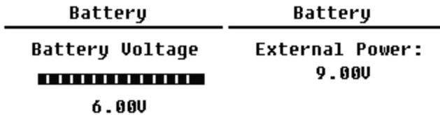
Das Menü „**Batterie**“ zeigt den Status und die Spannung der Batterie an. Die Entladeschlussspannung einer einzelnen Alkali-Batteriezelle LR6/AA/AM3 beträgt ca. 0,9V, daher schaltet das Schallpegelmessgerät automatisch ab, wenn die Gesamtspannung der 4 Zellen der Alkalibatterie unter 3,6 V fällt.
