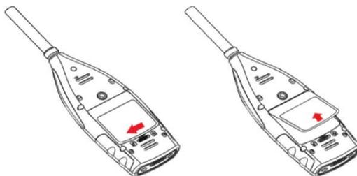
Schieben Sie die Abdeckungsverriegelung nach links, um die Batteriefachabdeckung zu entriegeln. Nehmen Sie die Batteriefachabdeckung ab.
