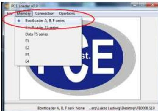
4. Gehen Sie nun unter „Connection“ – „Settings“ Interface settings und stellen die Parameter wie in der Waage ein. Port (wird von der Software automatisch gesucht) / **Baudrate: 115200 / Bits: 8 / Parity: None / Stop bit: 1**
