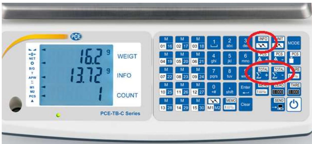
Um das auf der Waage befindliche Wiegergebnis in den Speicher zu übernehmen gibt es zwei Arten. Die eine Art ist die Summierung per Tastendruck. Die andere ist eine automatische Addierung wenn der
