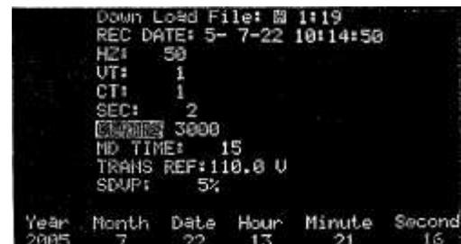
Um die 3000A Messzange auszuwählen, drücken Sie die Setuptaste und wählen mit der ▲ und ▼ Taste unter CLAMP die 3000 aus.
