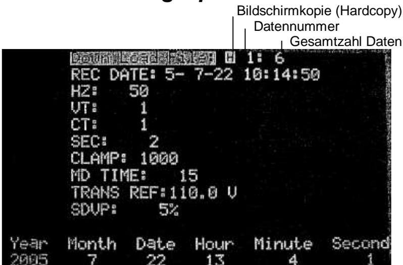
1. Drücken sie die [SETUP] Taste. „Down Load File“ wird nun hinterlegt dargestellt. Wenn der gespeicherte Datensatz eine Bildschirmkopie (Hardcopy) enthält, wird dieses durch ein hinterlegtes H dargestellt.
