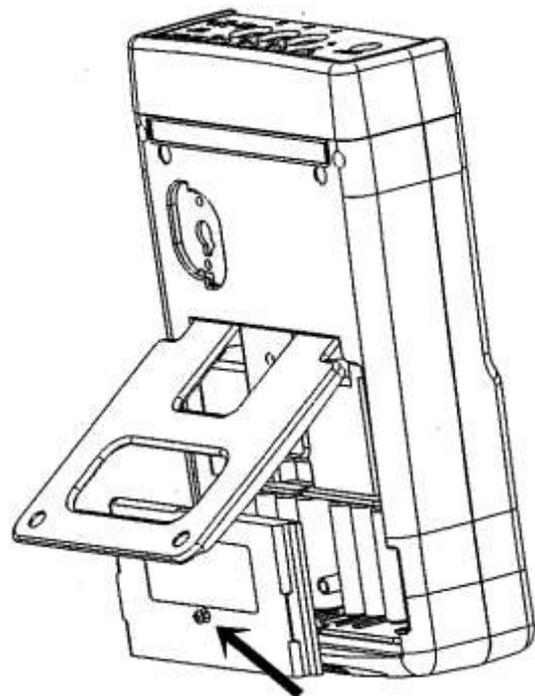
Wenn das Symbol für einen niedrigen Batteriestand angezeigt wird, ersetzen Sie bitte die alten Batterien durch 8 neue.
