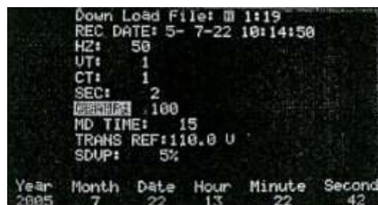
Um die 100A Messzange auszuwählen, drücken Sie die Setuptaste und wählen mit der ▲ und ▼ Taste unter CLAMP die 100 aus
