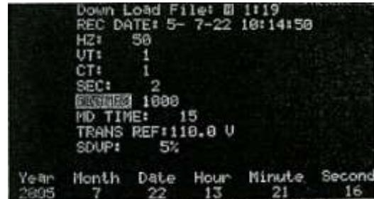
Um die 1000A Messzange auszuwählen, drücken Sie die Setuptaste und wählen mit der ▲ und ▼ Taste unter CLAMP die 1000 aus.
