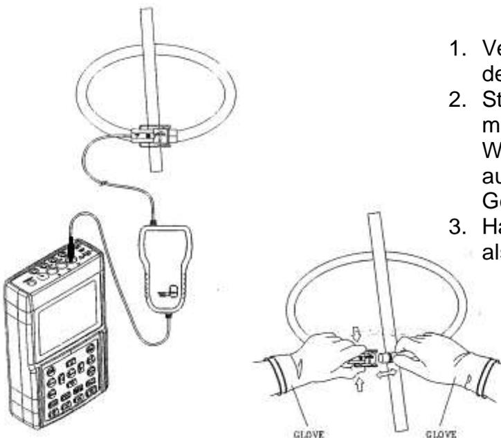
1. Verbinden Sie die flexiblen Messzangen um den Stromleiter herum.
