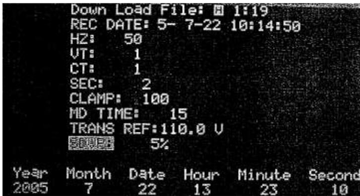
5. Drücken sie die ▲ bzw. ▼ Taste um den Grenzwert in % (SDVP) zu erhöhen bzw. verringern. Zum beenden drücken Sie bitte die [EXIT] Taste.
