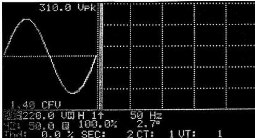
Wenn Sie die [MAG.] Taste drücken, wird der Wert jeder Wellenform dargestellt. Um einen vorherigen Wert des Phasenwinkels erneut anzuzeigen drücken Sie die [PHASE] Taste. Der Phasenwinkel wird neben dem Prozentwert angezeigt. Dieser Phasenwinkel wird aus den ermittelten Daten der Wellenformen ermittelt. Er sollte bei V1 nicht 0 betragen. Der Rest des Phasenwinkels (V2, V3, I1, I2, und I3) wird im Bezug auf V1 ermittelt
