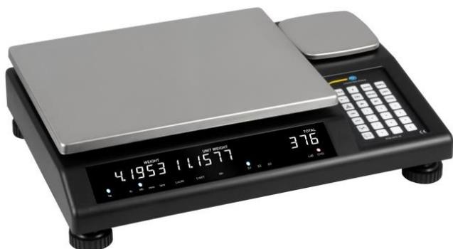
Übliche Zweibereichswaagen bieten für eine Wiegeplattform zwei unterschiedliche Auflösungen für direkt aufeinander folgende Gewichtsbereiche, zum Beispiel zwei Gramm für 15 Kilogramm und fünf Gramm für 30 Kilogramm. Bei der neuen PCE-DPS 25 sind statt dessen zwei voneinander unabhängige Wiegeplattformen in einem Gehäuse mit derselben Anzeige- und Bedieneinheit zusammengeführt.
