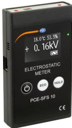
Das Elektrostatik Messgerät misst Aufladungen bis zu einer Höhe von 60 Kilovolt. Zusätzlich werden die Temperatur und die Luftfeuchte der Umgebung erfasst und angezeigt. Damit durch das Feldmeter die vorhandene elektrostatische Aufladung nicht beeinflusst wird, wurde es mit einem Anschluss für ein Erdungskabel versehen. Ein passendes Erdungskabel mit Krokodilklemme gehört zum Lieferumfang des Geräts.
