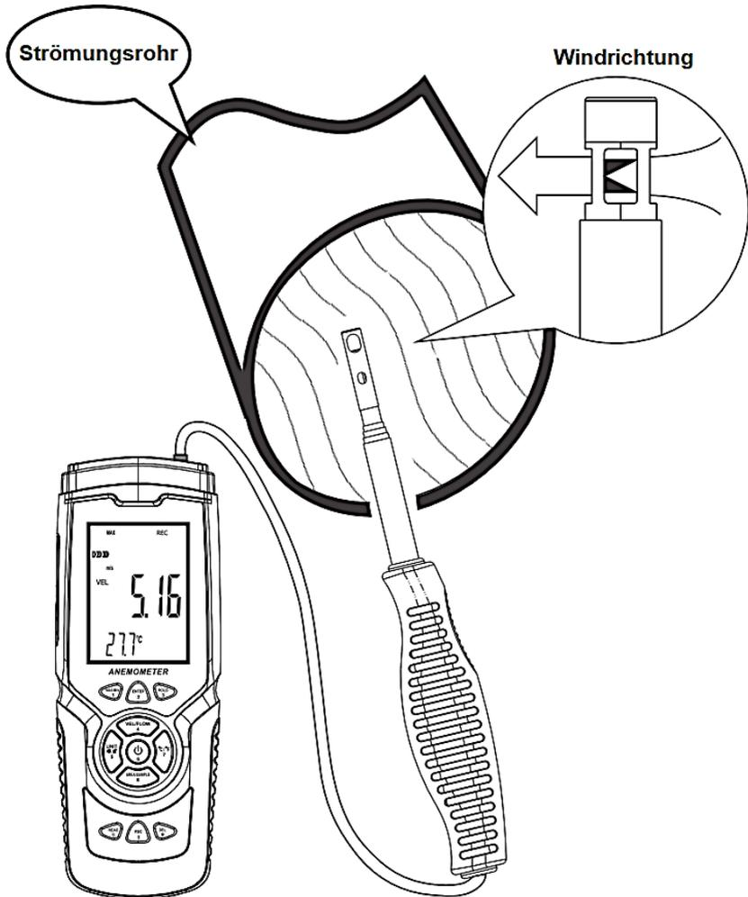
Um eine Messung durchzuführen, richten Sie den Strömungssensor zur Strömungsflussrichtung aus. Ein Pfeil auf dem Kopf des Sensors gibt dabei die Ausrichtung bezogen auf den Windströmungsfluss vor. Warten Sie mindestens zwei Sekunden, bis der Messwert sich stabilisiert hat.
