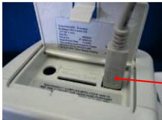
**USB-Kabel in der Steckbuchse**
