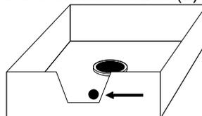
3. In diesen Ausschnitt wird der Griff der Einsetzhilfe (3) eingelegt.
