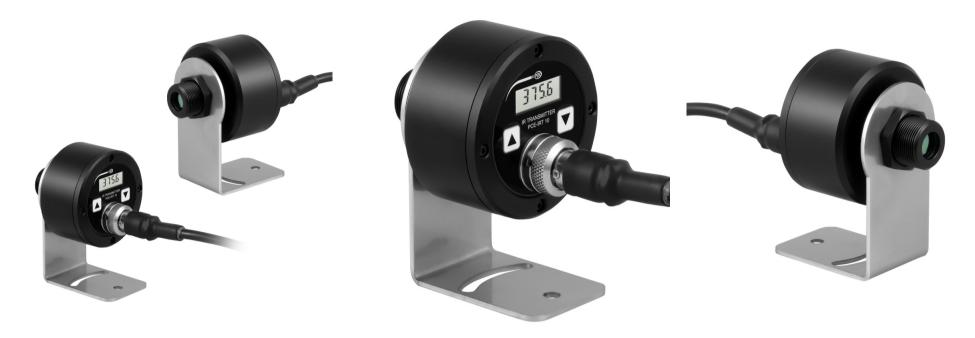
Infrarotthermometer zum Festeinbau / 4 ... 20 mA Ausgang / 0 ... 600 °C einstellbarer Emissionsgrad / Edelstahlgehäuse / IP65
