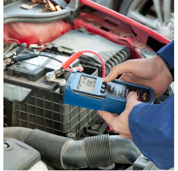
**Spannungsmessgerät** für 12 V und 24 V Starterbatterien / Anlasser und Ladekreis Messung /
