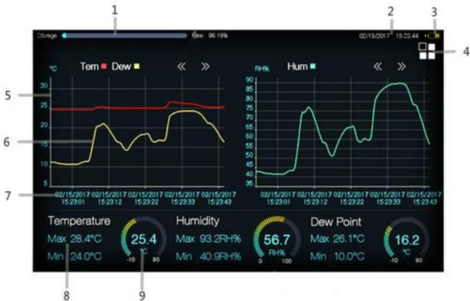
Wenn keine Eingabe erfolgt, schaltet der Datenlogger nach 1 Minute automatisch auf die Großanzeige der aktuellen Werte um. Diese Darstellung zeigt: Luftfeuchte (Humidity), Temperatur (Temperature) und Taupunkttemperatur (Dew Point).
