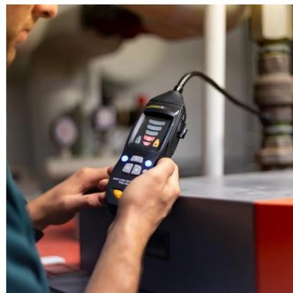
Der kompakte und einfach zu bedienende Gasdetektor PCE-GA 10 ermöglicht durch seine Bauart das einfache und schnelle Aufspüren vieler brennbarer Gase. Er ist damit sowohl in Betrieben einsetzbar als auch im privaten Bereich. Das Gasspürgerät warnt bei Gasansammlungen in Gebäuden, an Fahrzeugen und Maschinen und an Anlagen und Einrichtungen bei denen brennbare Gase entweichen können. Gefahren können so rechtzeitig erkannt und entsprechende Gegenmaßnahmen ergriffen werden.
