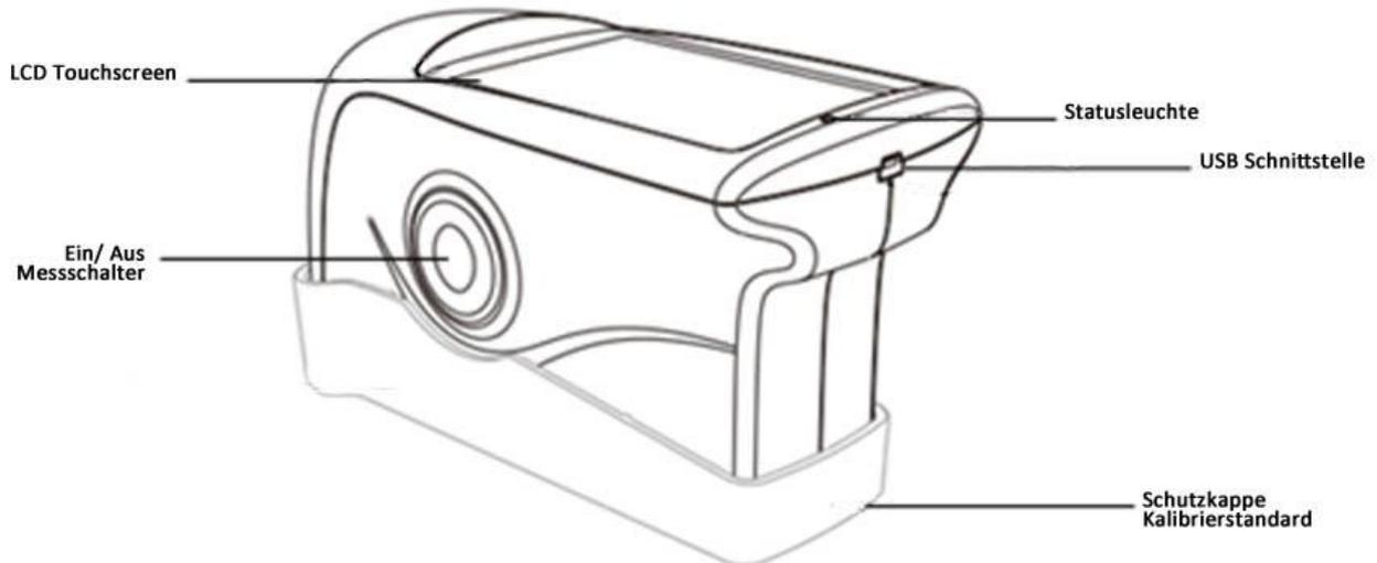
**LCD Touchscreen:** Farbdisplay zum Anzeigen der letzten fünf Glanzmesswerte. Außerdem dient der Bildschirm der Bedienung des Geräts.
