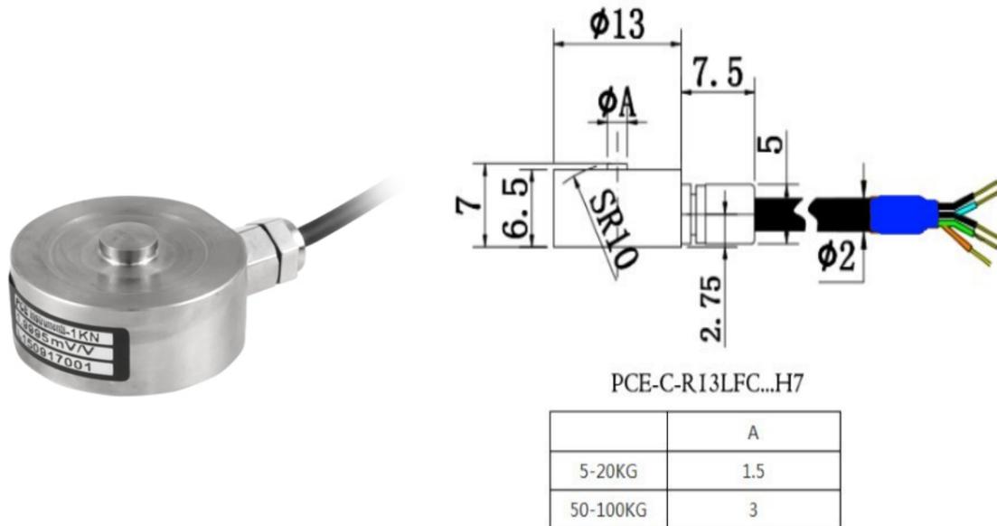
Ein Kraftaufnehmer aus nicht rostenden Stahl mit einer Messunsicherheit von nur 0,5 %. Mit den Abmessungen von  $\varnothing$  13 mm und einer Bauhöhe von 7 mm ist der Kraftsensor sehr vielseitig einsetzbar.
