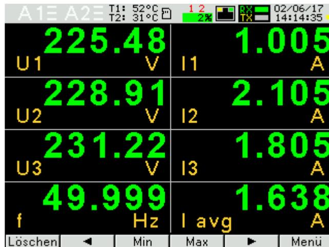
Abb. 11. Die Anzeige der Betriebsart Messung des Messgerätes
