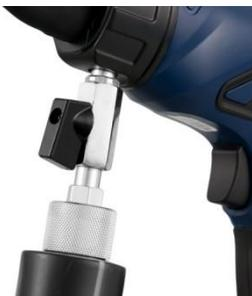
Endoskopkamera PCE-VE 250 mit geöffnetem Absperrventil.
