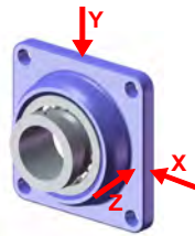
Bild 10: Messorte an Flanschlager
