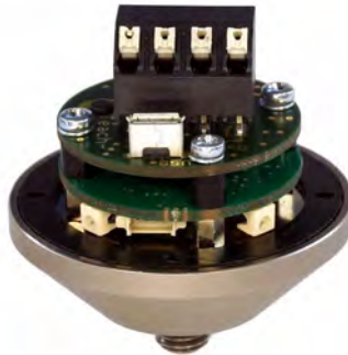
Bild 1: Anschlussklemmen und USB-Buchse im PCE-VS11
