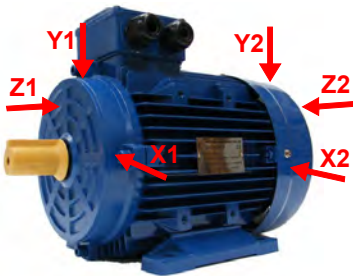
Bild 11: Messorte an Elektromotoren
