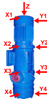
Bild 12: Messorte an Maschinen mit vertikalem Rotor
