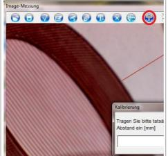
Kalibrierung: Hier kann eine Kalibrierung vorgenommen werden. Sie benötigen hierfür ein Bild, in welchem Ihnen ein Abstand bekannt ist, oder das beiliegende Kalibrierlineal. Diesen Abstand markieren Sie im Bild und geben in die Eingabemaske den bekannten Wert in Millimetern ein
