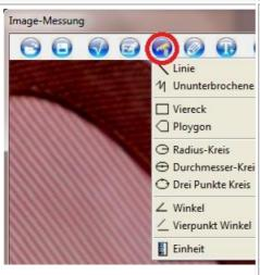
Messen: Nachdem eine Kalibrierung vorgenommen wurde, kann das Mikroskop für Messungen im Bild verwendet werden. Wählen Sie hierfür ein passendes Objekt (z.B. Drei-Punkte-Kreis) und markieren Sie die Messpunkte im Bild. Das Messergebnis wird angezeigt. Durch einen Mausklick kann das Ergebnis im Bild eingezeichnet werden
