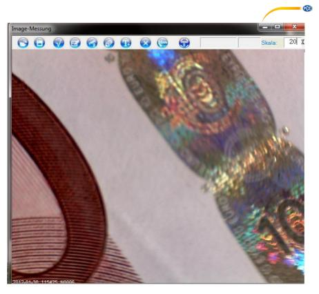
(6) Lesen Sie nun auf dem Gerät die Zoomstufe ab und tragen Sie diese in das Feld "Skala" ein. Der Skalenwert dient als Referenz für Messungen, die Sie später in dem Programm durchführen können.
