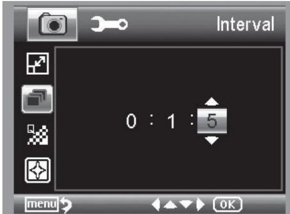
Stellen Sie das Intervall ein, in dem Bilder gemacht werden sollen. In dem Beispiel oben wird alle 15 Sekunden ein Bild aufgenommen. Um Verwackelungen beim Auslösen einer einzelnen Aufnahme zu verhindern, stellen Sie das Intervall auf 0:0:0 und drücken anschließend die Aufnahmetaste. Dann wird mit einer Zeitverzögerung von ca. 2 Sekunden eine Aufnahme gemacht.
