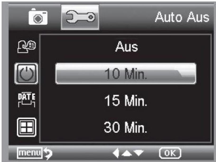
Wenn der Energiesparmodus Auto Aus eingeschaltet ist, schaltet sich das Gerät nach der eingestellten Zeit automatisch aus. Dadurch verlängert sich die Laufzeit der Batterie. Um den Energiesparmodus zu deaktivieren, wählen Sie Aus.
