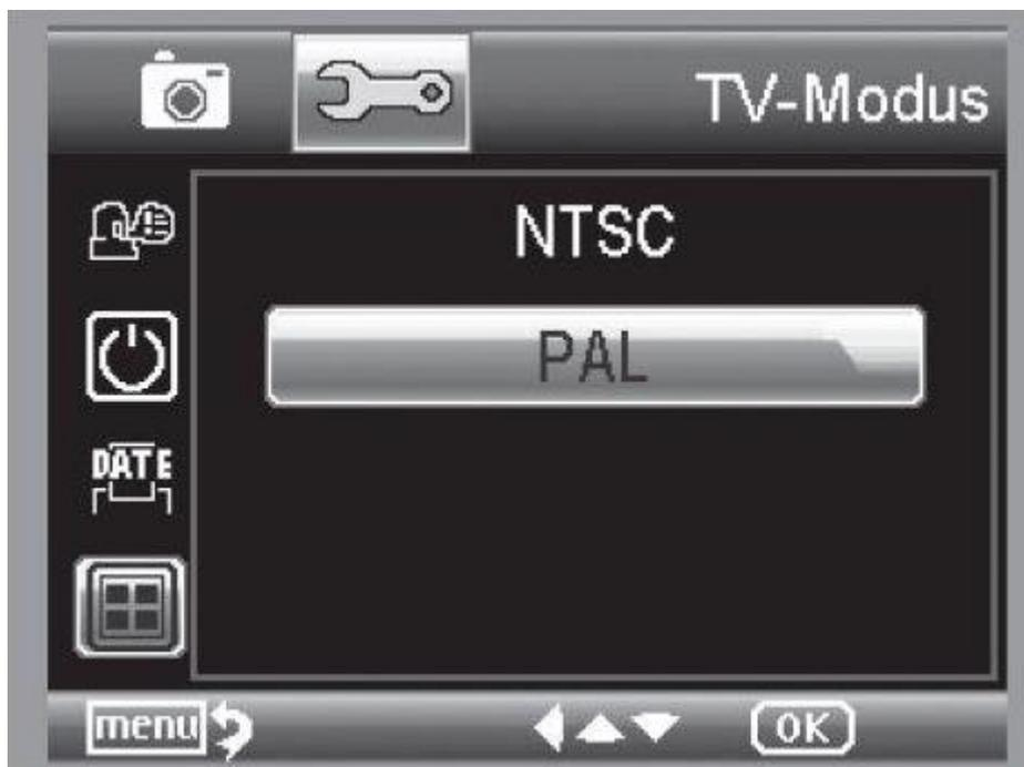
Das Gerät verfügt über einen AV-Ausgang, an den man einen Fernseher anschließen kann. Stellen Sie für Europa die Fernsehnorm auf PAL. Stellen Sie über das AV Kabel eine Verbindung zum TV Gerät her, wird der Monitor des PCE-DHM 10 automatisch ausgeschaltet, nach dem Trennen des AV-Kabels startet der Monitor wieder.
