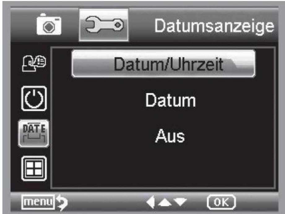
In dieser Einstellung kann festgelegt werden, ob das Datum und die Uhrzeit oder nur das Datum im Bild eingeblendet wird. Wenn Sie Aus gewählt haben, wird nichts im Bild eingeblendet. Die Anzeige des Datums erfolgt auf den gespeicherten Aufnahmen.
