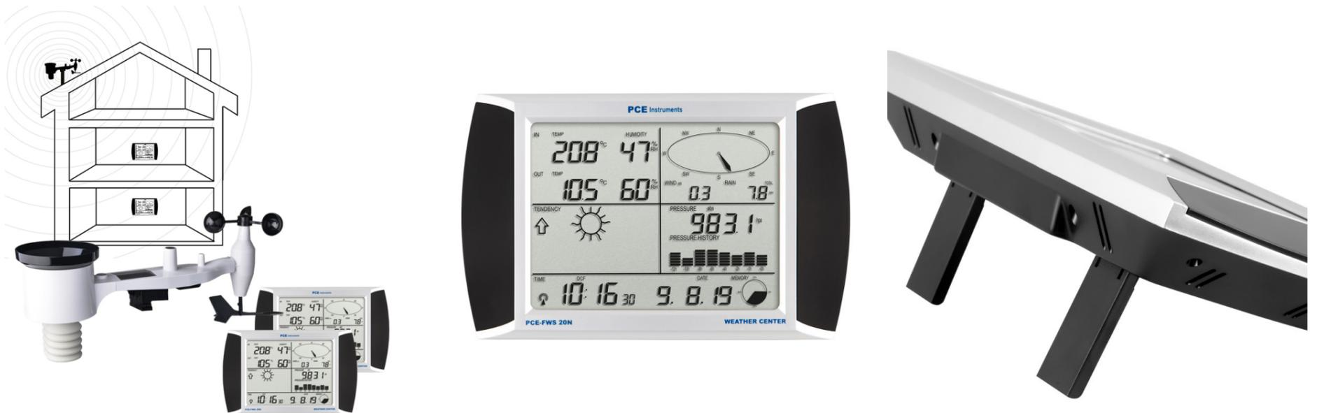
Funkwetterstation zur bestimmung der Windrichtung, Windgeschwindigkeit, Temperatur, relative Luftfeuchte und Regenmenge / einstellbare Alarmfunktionen / USB-Schnittstelle / Analyse-Software / Solarmodul und Batterien für die Stromversorgung des Transmitters / Übertragungsfrequenz: 868 MHz
