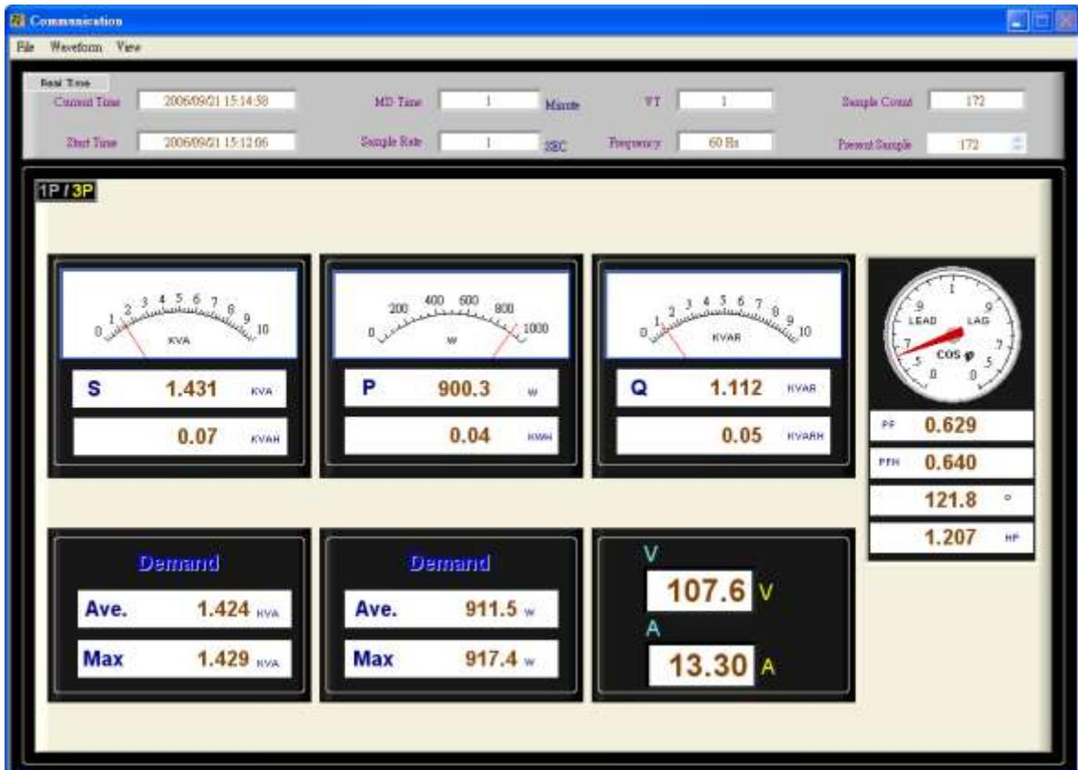
In der Werkzeugleiste können Sie auswählen, welche Funktion Sie benutzen wollen. Datei öffnen (Open), Messdaten speichern (Save), Datei schließen (Close), Demand Time und die Wiederholungsrate (MD Time & Sample Rate), Bildschirm drucken (Print), als Grafik anzeigen lassen (Waveform) und Beenden (Exit).
