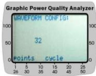
**WAVEFORM CONFIG:** Stellt ein wie viele Punkte bei jedem Durchgang der Schwingungsanzeige aufgenommen werden sollen. Vier Möglichkeiten sind einstellbar: 32, 64, 128, 256.
