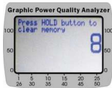
Wenn Sie die HOLD Taste nicht für 8 Sekunden gedrückt halten, wird der Speicher nicht geleert. Dies verhindert, dass der Speicher unabsichtlich gelöscht wird.
