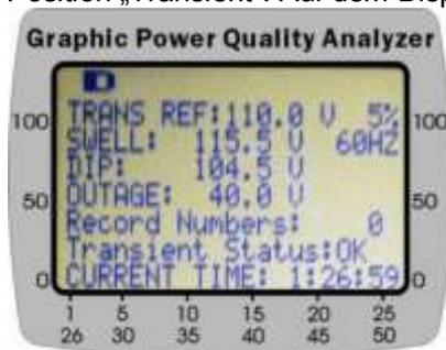
Es wird Ihnen die Referenzspannung (TRANS REF) von 110V mit einem Schwellwert von 5% angezeigt. Wenn die Spannung 115,5V (SWELL) überschreitet oder die Spannung kleiner als 104,5V (DIP) ist oder kleiner als 40V (OUTAGE) dann wird eine Störung aufgezeichnet.
